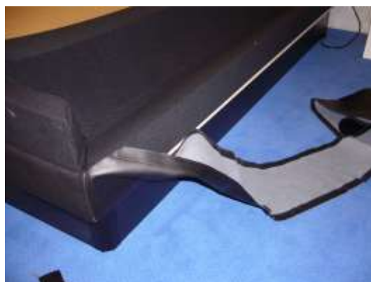
Fig. 6. Dekorationskanten monteres på den nederste del af skumsiderne. Start påsætning i fodenden og afslut i hovedenden. Dekorationskanten fastgøres på bundpladens underside, hvor velcro er monteret. Dekorationskantens overside fastgøres på toppen af den nederste skumside.
